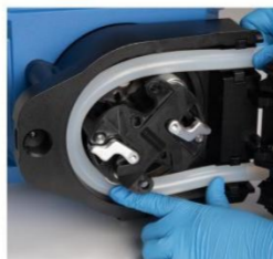
3. 将软管安装至泵头内，将其平顺的放置管卡对应位置。
