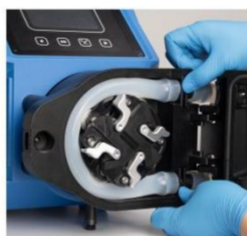
3. 将内置管组件安装至泵头内，管接头按压到对应凹槽内。
