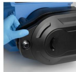
5. 合上泵头壳体，完成软管安装。
