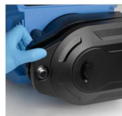
5. 合上泵头壳体，完成软管安装。
