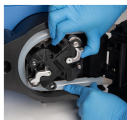
4.旋转滚轮总成，将滚轮通过板杆扳到工作位置。
