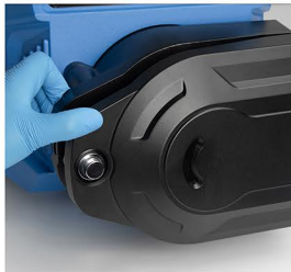
4. 合上泵头壳体，完成软管安装。
