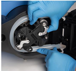
3. 旋转滚轮总成，将滚轮通过板杆扳到工作位置。
