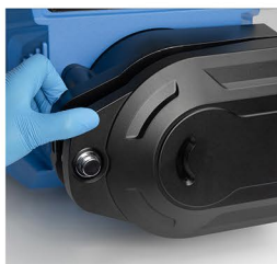
4. 合上泵头壳体，完成软管安装。
