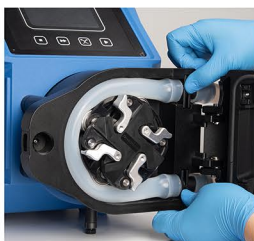
2. 将内置管组件安装至泵头内，管接头按压到对应凹槽内。
