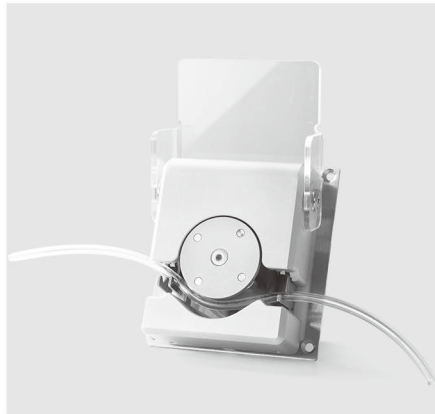
2.将软管放入滚轮与下部的上压块之间，分别放入两侧的管卡中。
