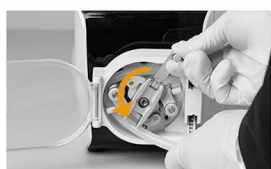
2.将软管放入两导向柱之间, 手握扳手, 转动滚轮主体
