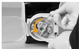
2.将软管放入两导向柱之间,手握扳手,转动滚轮主体
